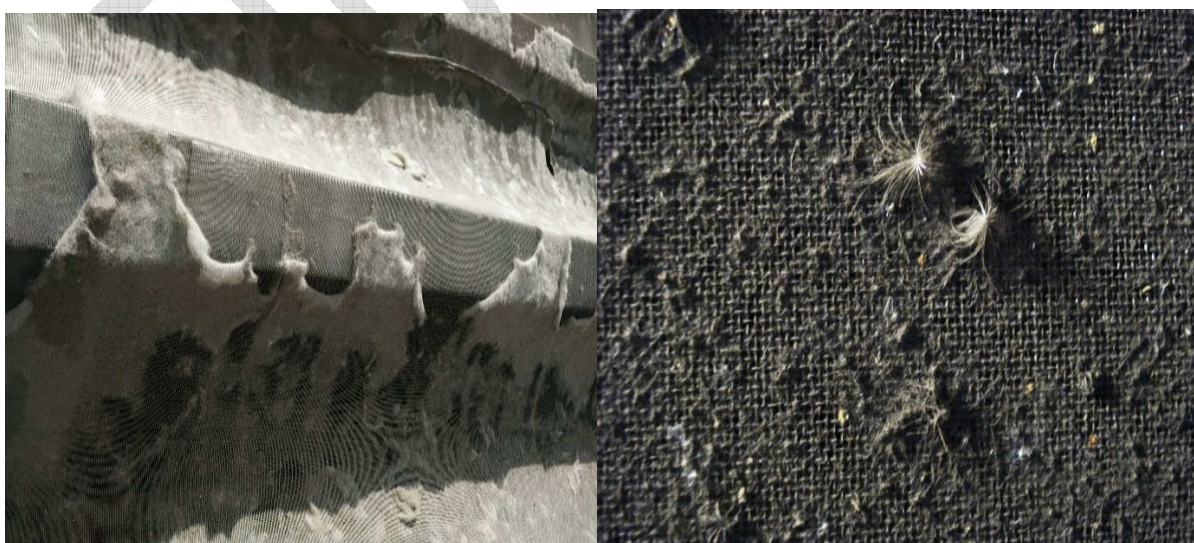
Рис. 2.36. Интенсивность заноса противомоскитных сеток: а) тополиным пухом; б) несгоревшими углеводородами и одуванчиками
