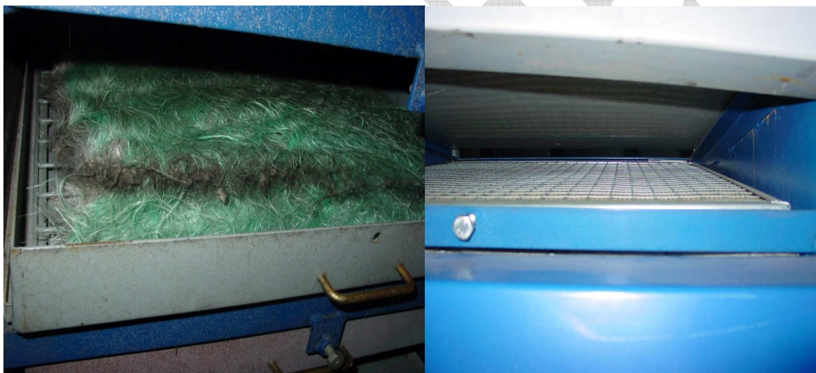
а) б) Рис. 1.3. Фильтры грубой очистки: а) коагулятор PS-50; б) ФяВ
