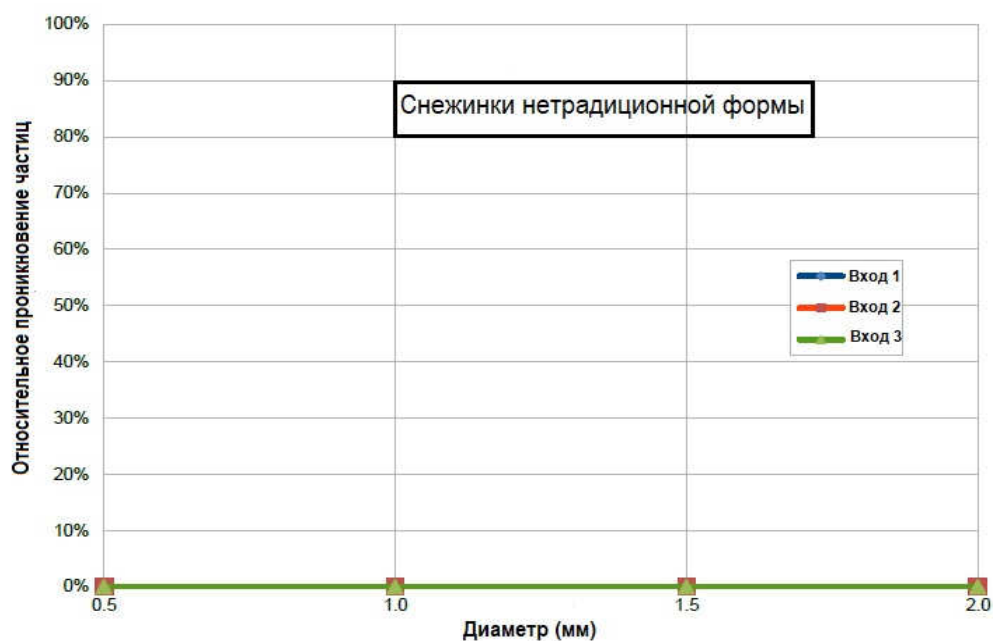
Рис. 2.21. Проникновение снежинок нестандартной формы на всас КВОУ по ярусам
