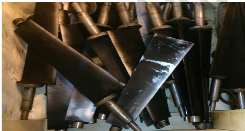
Рис. 3.8. Лопатки ВНА компрессора GE PG935FA Шатурской ГРЭС [3]
