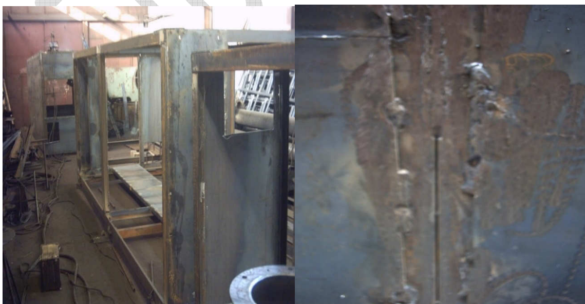
Рис. 1.13. Изготовление модулей КБОУ: а) коррозионный металл; б) качество сварки
