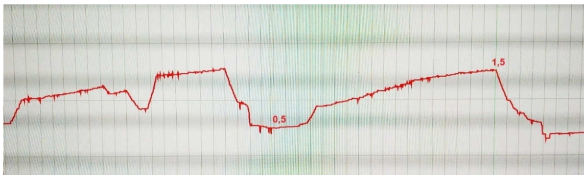
Рис.2.37. Тренд роста перепада давления на штатных противомоскитных сетках 18.06.2018
