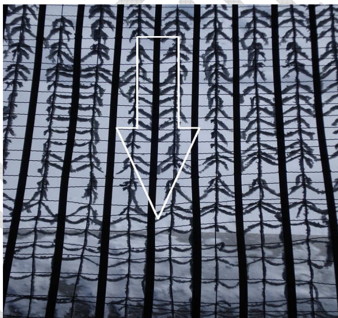
Рис.2.50. Изменение плотности инея по высоте сетки от птиц и мусора [15]
