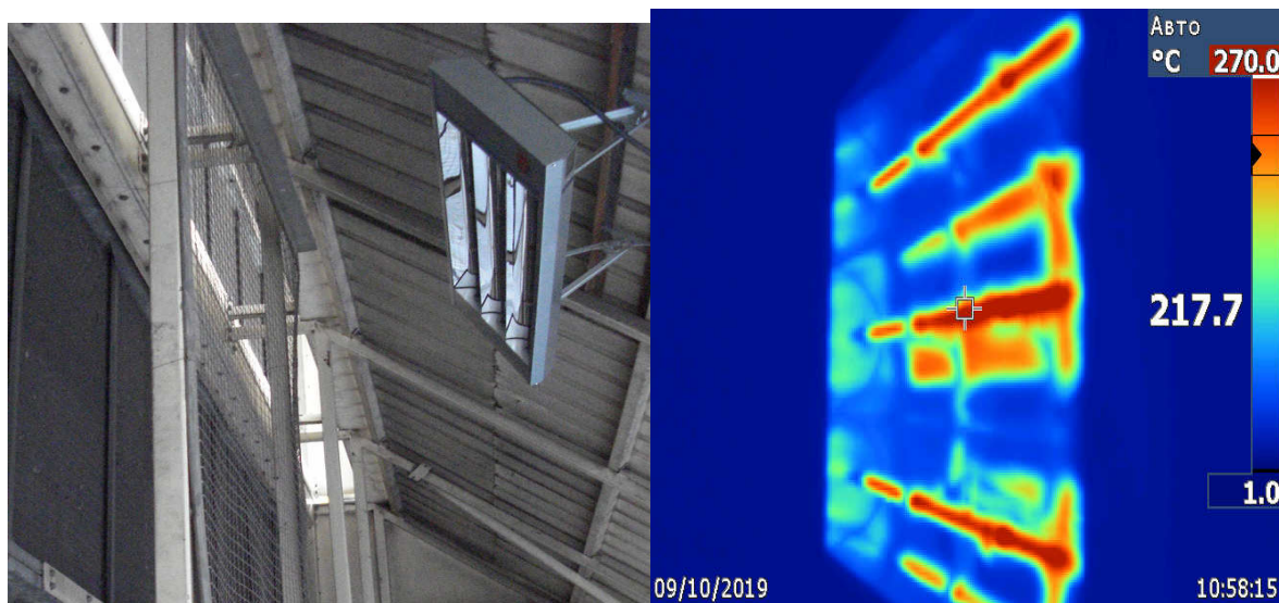
Рис. 2.65. ИК-обогреватель в КВОУ ГТУ: а) ИК-обогреватель; б) термограмма лампы
