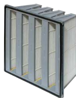
Компактный W-образный фильтр EV-G материал: синтетика рамка: полистирол класс: G4
